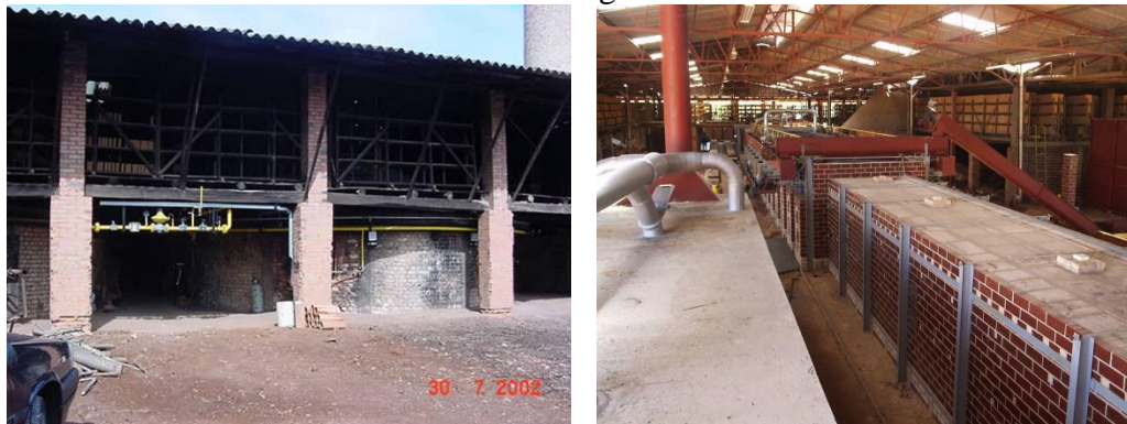
Figura 2 - Modelos de fornos alternativos de energia em uma cerâmica vermelha.
