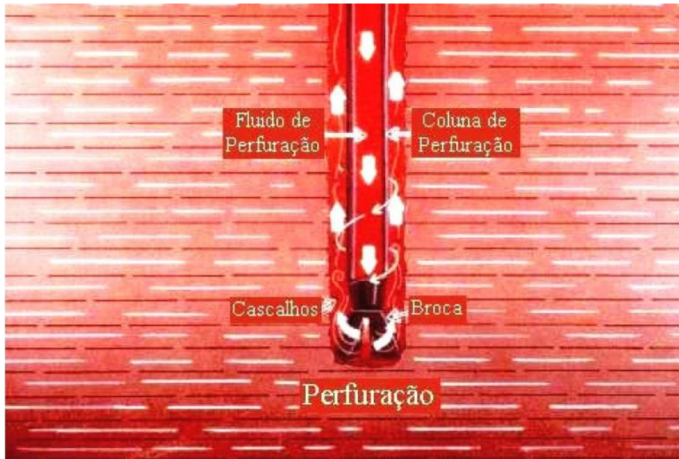
Figura 12 – Fluido de perfuração carreando os cascalhos para a superfície
